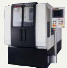
最适于曲轴加工生产线的 MQL高效加工单元 DH524
