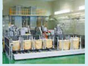
金属屑固化再循环系统
