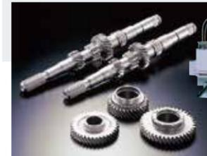
变速齿轮的真空浸碳处理
