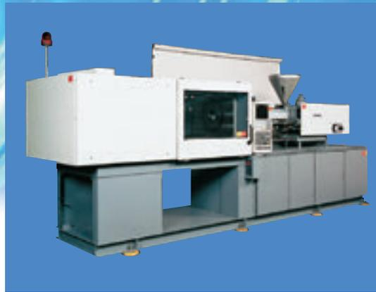
使用油压机器的射出成形机
