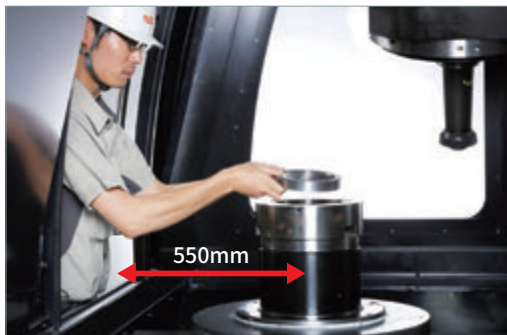
工件装卸、工艺准备简单 与夹具间的距离短, 方便作业者靠近
